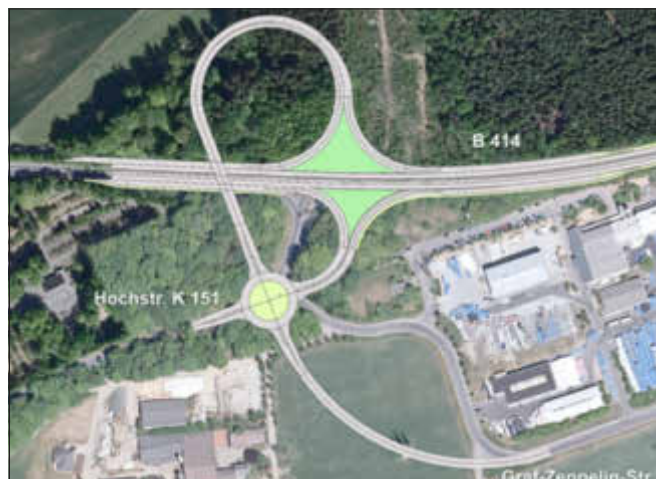
Skizze der geplanten kreuzungsfreien Anbindung der Hochstraße
