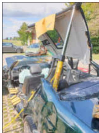
„Große Rettungsöffnung“ nach dem Entfernen von Tür und B-Säule
